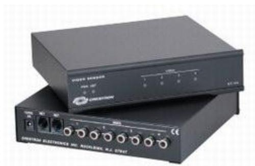
ST-VS是一个快思聪扩展模块，用于传感来自最多可达4个独立设备(例如VCR和DVD播放器)的基带视频信号。视频传感的典型应用是提供设备电源开/关状态确认。通常需要为红外控制协议中不包括离散电源命令的红外控制设备启用可靠的电源控制。ST-VS可用于在需要时提供视频传感接口，也可以通过可选的ST-RMK机架安装工具箱(单独出售)来进行机架安装。与控制系统的通信通过单个快思聪网络连接来实现。
